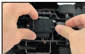
Step 3 - Close Battery Door
