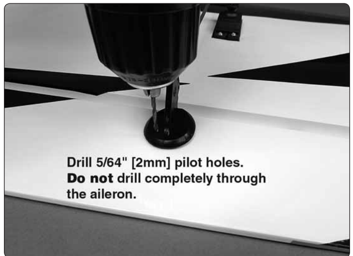
□ □ 10. Position control horn on aileron.
