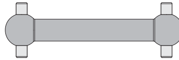
88003 Drive Shaft 9x40mm Antriebswelle 9x40mm Axe transmission 9x40mm ドライブシャフト 9x40mm
