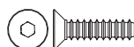
OT242 ⑦ x13 Flat Head Tapping Screw (M3x12) サラタッピングビス
