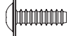
OT242 ⑩ / OTB246 ⑪ x6 Flange BH TP Screw (M3x10) フランジボタンタッピングビス
