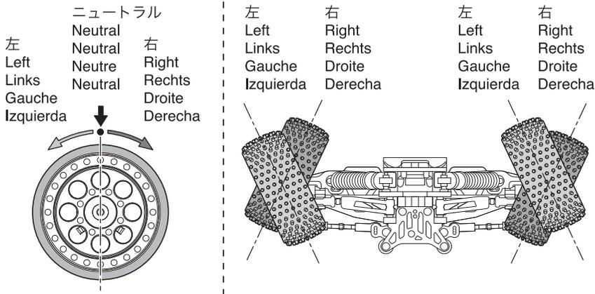
\*ステアリングホイールの操作量に応じて舵角が変わります。操作量が大きいほど、舵角も大きくなります。
