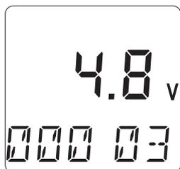
▶ LCDの電圧表示が4.8Vを示したらすぐに乾電池を新品と交換してください。
