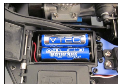
Portabatteria nella scatola della batteria
