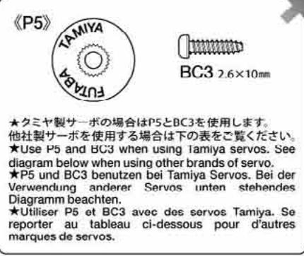
★サーボがニュートラルの状態での図のように取り付けます。
