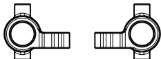
Y2-415FR ステアリングブロック L & R 各 1 Steering Block L & R 1Ea
